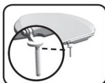
2. Posicione o pino do assento para ambos os lados no eixo do aro e remonte a tampa. Atente para que a seta indicativa de montagem localizada no pino de fixação esteja direcionada para frente da louça;
