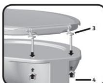
3. Posicione os componentes: pino de fixação (3) e porca do pino de fixação (4);
