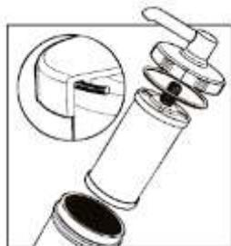
2. Ao trocar o elemento filtrante, verifique se o anel está devidamente alojado na cavidade da tampa. Rosqueie o elemento filtrante na tampa e remonte o conjunto 'elemento filtrante+tampa' no copo do purificador;
