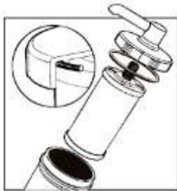
2. Ao trocar o elemento filtrante, verifique se o anel está devidamente alojado na cavidade da tampa. Rosqueie o elemento filtrante na tampa e remonte o conjunto 'elemento filtrante+tampa' no copo do purificador;
