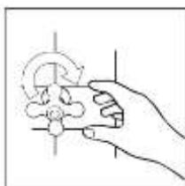
1. Feche o registro geral e limpe a conexão na qual a torneira será instalada;
