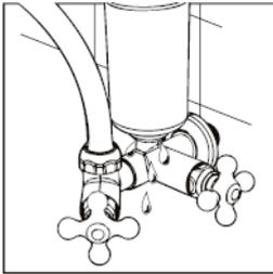
1. Em caso de vazamento, repita os procedimentos de instalação, verificando as conexões e o aperto do purificador;
