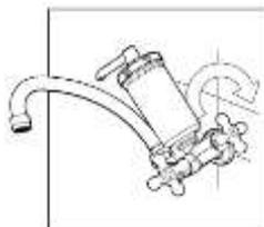
2. Aplique fita veda rosca (vendida separadamente) na conexão da torneira e instale a torneira na conexão da parede, aplicando apenas o torque necessário para que fique firme;
